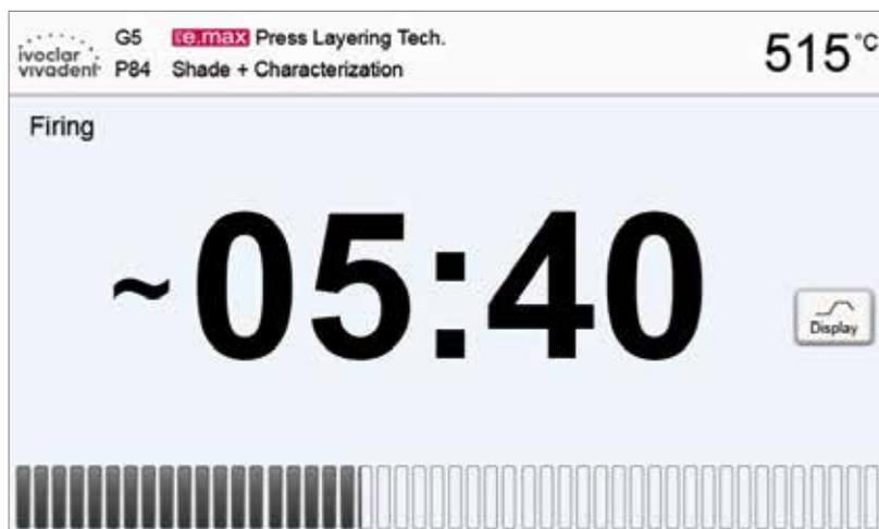
Le four est paramétré, au départ de l'usine, de façon à ce que le mode Courbe de cuisson soit automatiquement affiché au démarrage d'un programme.
