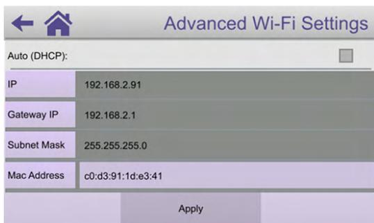
En appuyant sur **Advanced** (Avancé) sur l'écran **Settings** (Paramètres), l'écran **Advanced Wi-Fi Settings** (Paramètres Wi-Fi avancés) s'affiche. Sur cette page, l'utilisateur peut saisir manuellement l'adresse IP, l'adresse IP de la passerelle et le masque de sous-réseau.
