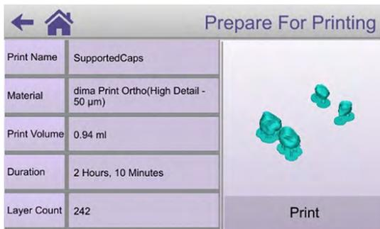
En appuyant sur **Continue** (Continuer) sur l'écran **Material and Quality** (Matériau et qualité), l'utilisateur accède à l'écran **Prepare For Printing** (Préparation à l'impression). Sur cette page, l'utilisateur a une vue d'ensemble des paramètres d'impression qu'il a sélectionnés pour le projet à imprimer.
