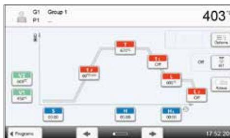
Lorsque les paramètres de la deuxième étape du refroidissement lent ont été entrés, les phases de montée en température et de refroidissement sont visibles sur deux écrans de programme séparés.
