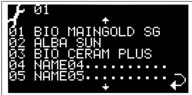
Mit dem Drehgeber wird eine der 5 Einträge selektiert und durch Drehgeber-Druck an den Legierungseditor übergeben. Werden die Pfeil-Hoch/Runter-Felder selektiert, erscheinen die nächsten 5 Einträge (6..10, 11..15, 16..20, 21..25).
