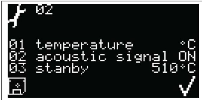
In Zeile 01 kann für die Temperaturanzeige zwischen °C oder °F gewählt werden. In Zeile 02 kann der Signalgeber ein- oder ausgeschaltet werden. In Zeile 03 wird die Standby-Temperatur in einem Bereich von 500..900°C festgelegt. Das Zurück-Icon wechselt zum Setupmenü; die gewählten Einstellungen bleiben bis zum Ausschalten des Gerätes aktiv.
