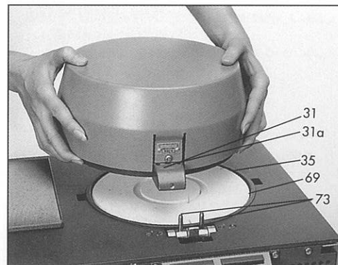
Fig 5 : placer les chevilles-charnières (73) en position verticale (Fig 5)
